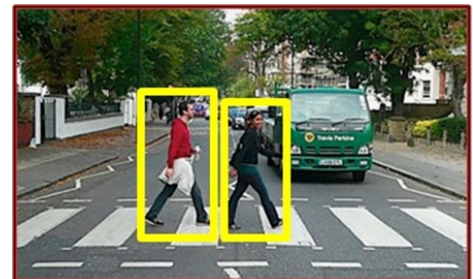
خروجی سیستم تشخیص عابر پیاده مستطیل‌های محاطی به دور افراد است.
